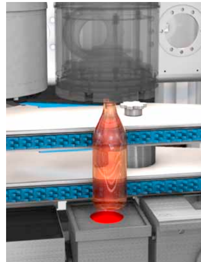
Inspección de la rosca completa
