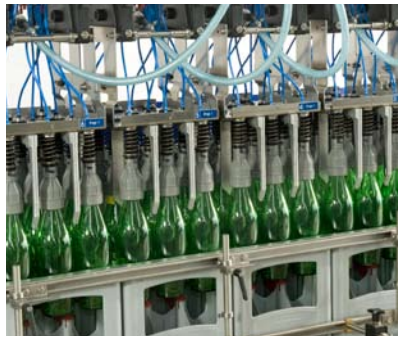
Cabezal de agarre fijo para sacar botellas de vidrio de embalajes retornables
