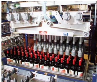
Cabezal de agarre de regulación mediante husillo para el tratamiento de diferentes diámetros de envases
