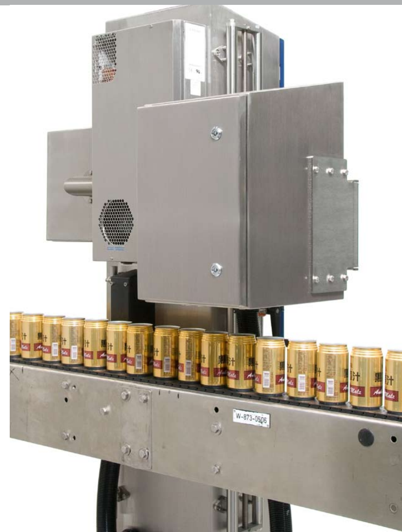
Unidad de cámara con climatización
